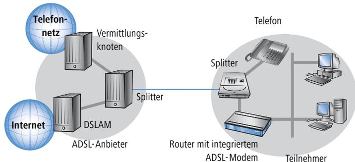
Der Betrieb von ADSL ist sowohl über ISDN- als auch über analoge Telefonanschlüsse (POTS – **P**lain **O**ld **T**elephone **S**ervice) möglich. Geräte mit integriertem ADSL-Modem werden jeweils in zwei Versionen angeboten. Die Angabe des unterstützten Telefonsystems finden Sie auf der Typenbezeichnung auf der Unterseite des Geräts. Der Gerätename ist auf dem Etikett mit einem Zusatz versehen, der für das unterstützte Telefonsystem steht:
