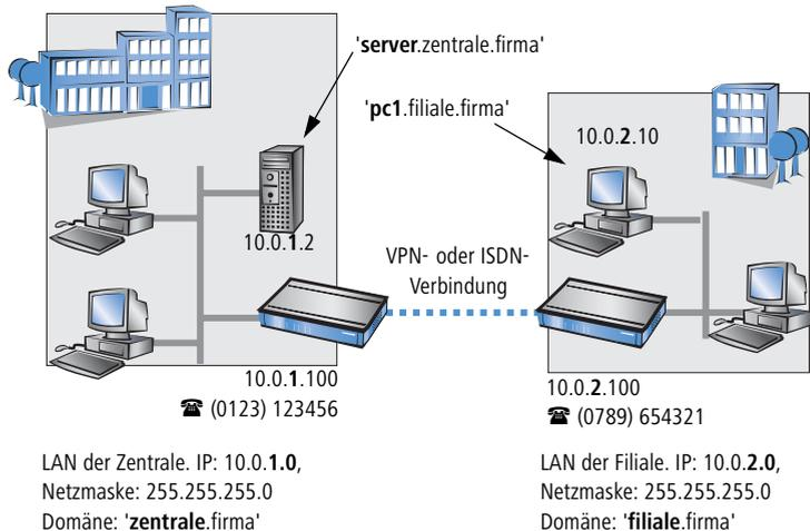
Im Gegensatz zum Internet-Zugang werden bei der Kopplung von Netzen alle IP-Adressen aus den beteiligten Netzen auch im entfernten LAN sichtbar, nicht nur die der Router. Der Rechner mit der IP-Adresse 10.0.2.10 im LAN der Filiale sieht den Server 10.0.1.2 in der Zentrale und kann (entsprechende Rechte vorausgesetzt) auch auf ihn zugreifen. Gleiches gilt umgekehrt.
