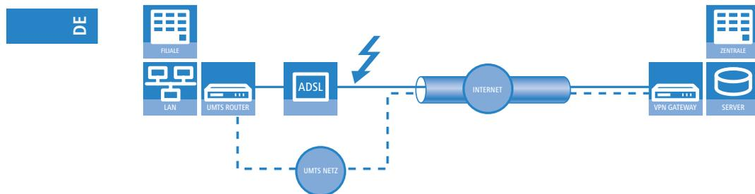
Als Alternative zu diesem ISDN/Analog-Backup-Verfahren kann auch eine Mobilfunk-Verbindung die Verfügbarkeit der Datenverbindungen sicherstellen. Wenn die Anbindung an das Internet über einen LANCOM 1751 UMTS erfolgt, kann die Mobilfunk-Verbindung sofort einspringen, wenn die ADSL-Leitung gestört ist. Das LANCOM 1751 UMTS unterstützt dabei alle aktuellen Mobilfunk-Techniken: GPRS, EDGE, UMTS und HSxPA.
