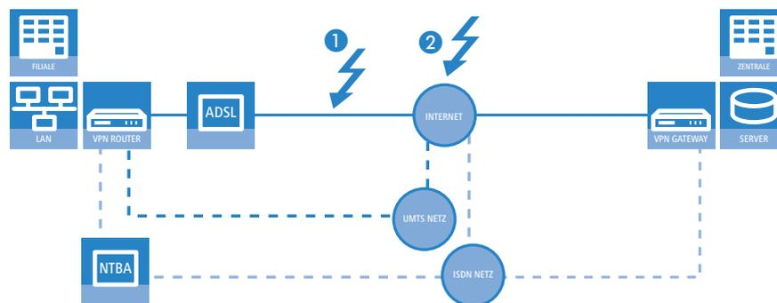
LANCOM UMTS Router vom Typ LANCOM 1751 UMTS bieten mit dem UMTS-Modem sowie der ISDN-Schnittstelle gleich zwei integrierte Möglichkeiten für den Aufbau von alternativen Verbindungen. Das Betriebssystem LCOS bietet dazu eine Reihe von Sicherheits- und Backup-Funktionen, mit denen Sie Ihr standortübergreifendes Netzwerk vor den Folgen dieser Störungen schützen können.
