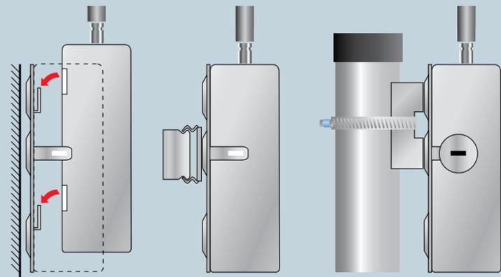
Rasten Sie das Gehäuse des Gerätes mit den vier rückseitigen Öffnungen in den Laschen der Grundplatte ein.
