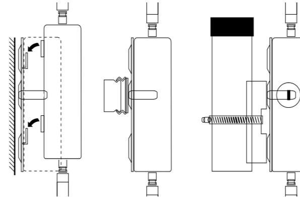
Rasten Sie das Gehäuse des Gerätes mit den vier rückseitigen Öffnungen in den Laschen der Grundplatte ein.
