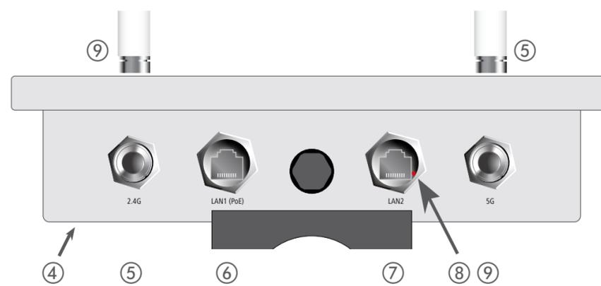
④ **Erdungsanschluss (Geräte-Unterseite)**
